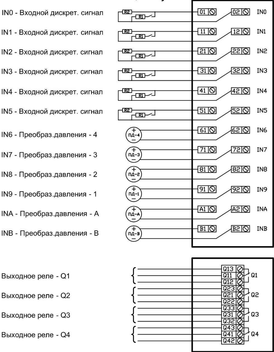
Рис.4 Схема подключения сигнальных цепей прибора
